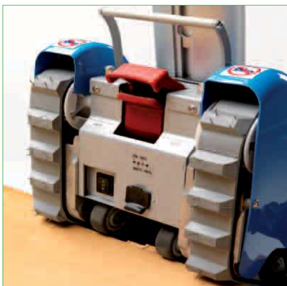
Podwójna blokada, elektryczna i mechaniczna, zaczełu kolumny sterującej do korpusu silnika
